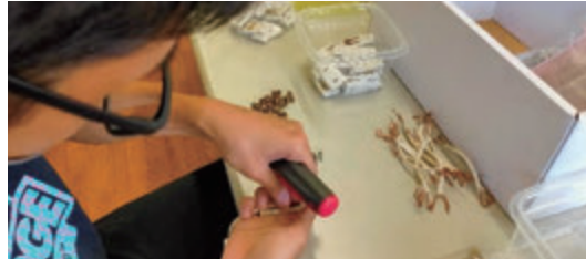
<コンセント組立作業>
